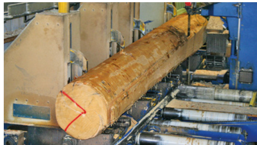
Das Bloch wird zersägt. Aus dem Stamm wird nun Fensterholz.
